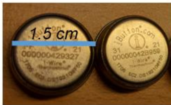
iButtons meten de temperatuur van de lucht en het bodemoppervlak
